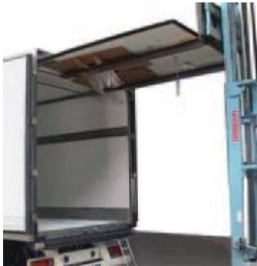
Heben Sie die komplette Frigo58 mit einem Gabelstapler mit verlängerten Gabeln (mind. 1,85 m lang) oder anderen Hebezeugen an (z. B. einem Scherenhubwagen).
