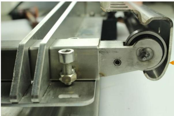
Stellen Sie das Rad so ein, dass es in der IsoLok-Schiene liegt wie in der Abbildung gezeigt.
