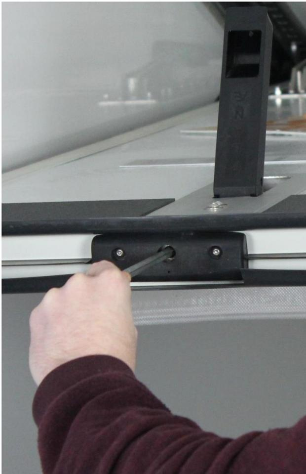
Stellen Sie die Bodenanschlüge unten mithilfe eines Innensechskantschlüssels (10 mm) ein.
