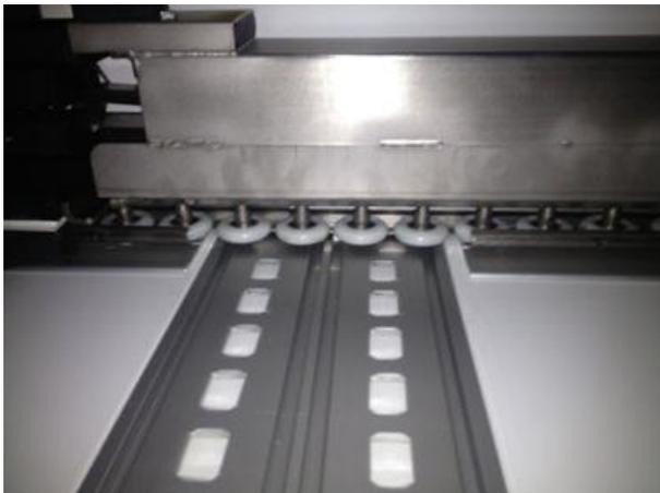
Die Laufräder des Ausgleichsreglers sind ausgefahren, wie in der Abbildung dargestellt.
